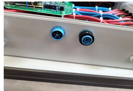
Abbildung 15: Steuerleitungen Anschluss Schaltbox(en)
